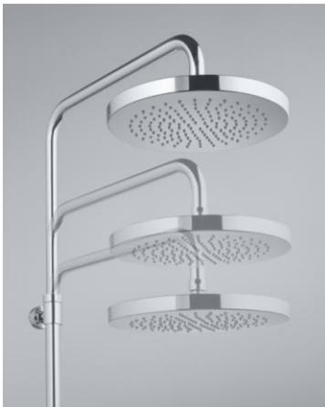
Bis zu 30 cm Höhentoleranz eröffnen bei der Montage der wasserführenden Duschstange neue Möglichkeiten, so dass auch bei sehr niedriger Deckenhöhe nicht mehr auf den maximalen Duschkomfort verzichtet werden muss. Für eine noch größere Flexibilität hat KLUDI zusätzlich einen stufenlos einstellbaren Brausearm für die Kopfbrause entwickelt. So kann der seitlich schwenkbare Brausearm bei der Installation optimal auf die Einbausituation und die Duschgewohnheiten der Benutzer abgestimmt werden.
